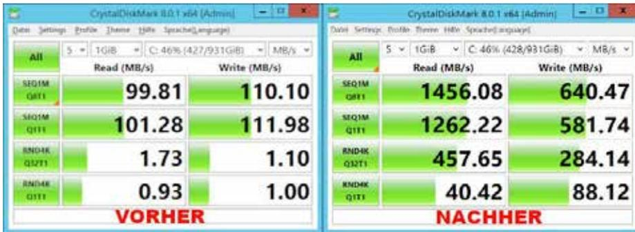
In diesem Beispiel konnte die Geschwindigkeit beim Lesen um das 15fache und das Schreiben um das 6fache erhöht werden. Dabei ist die Größe der Festplatte für die Geschwindigkeit nicht entscheidend. Eine Festplatte mit 128 GB kann genauso langsam oder schnell sein wie eine Festplatte mit über 1.000 GB.
