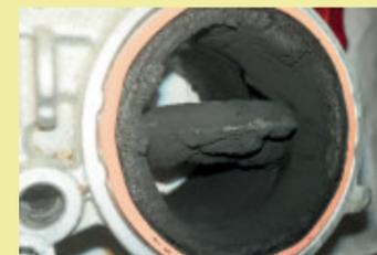
Abb. verschmutzte Ansaugbrücke
